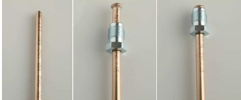
5. Die sauber getrennten und entgrateten Leitungsenden der Ersatzleitung sind mit einem Bördelgerät (gemäß Fahrzeugherstellerangabe) mit der vorgesehenen Bördelform (E oder F) zu bördeln. Es muss die Bördelform des Originalteils verwendet werden.
