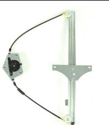
Alzacristallo originale - oem window regulator - lève-vitre original - Fernsterheber von oem - elevavunas original - levantator de vidro original - original cam acacagi - Γρύλος γνήσιος
