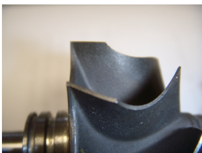
Turbina dello scarico senza danni
