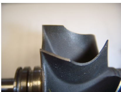
Turbine d'échappement en bon état
