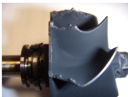
Turbina scarico danneggiata
