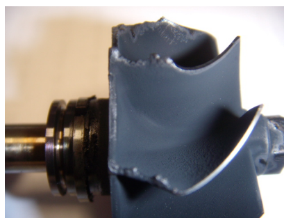
Poškozená výfuková turbína
