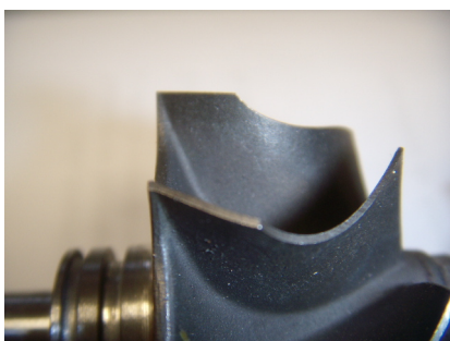
Nepoškozená výfuková turbína
