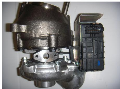
Pode acontecer que, depois de montado no veículo, o turbo não funcione corretamente, visto que a UCE ou DDE tem de ser reprogramada por um serviço oficial para o seu correto funcionamento, dado que o regulador de posição e as funções de diagnóstico estão integrados no servomotor.
