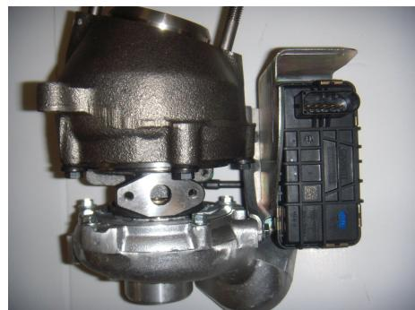
Puede ocurrir que el turbo una vez montado en el vehículo, no funcione correctamente, dado que tiene que ser reprogramada la UCE, o DDE por parte de un servicio oficial, para su correcto funcionamiento, dado que el regulador de posición y las funciones de diagnóstico están integradas en el servomotor.
