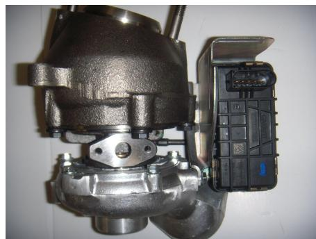
Může se stát, že po namontování do vozu nebude turbodmychadlo správně fungovat. Aby řádně pracovalo, je nutné v oficiálním servisu přeprogramovat UCE nebo DDE, protože regulátor polohy a funkce diagnostiky jsou integrované v servomotoru.
