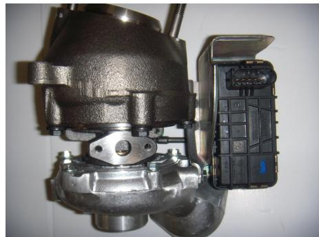
Het is mogelijk dat hij na de montage in het voertuig niet juist functioneert omdat de ECU of DDE opnieuw moet worden geprogrammeerd door een officiële service opdat hij juist zou werken. De regeling van de positie en de diagnosefuncties zijn namelijk in de servomotor geïntegreerd.
