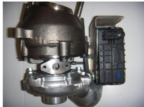
Può succedere che il turbo, una volta montato sul veicolo, non funzioni correttamente dato che, affinché funzioni correttamente, la UCE o la DDE deve essere riprogrammata presso un servizio tecnico ufficiale poiché il regolatore di posizione e le funzioni di diagnosi sono integrate nel servomotore.
