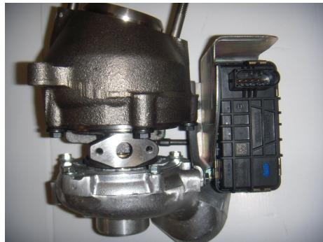
Il peut arriver que, une fois le turbo monté sur le véhicule, il ne fonctionne pas correctement, car il s'avère nécessaire de reprogrammer l'UCE, ou la DDE, par un service agréé, pour son fonctionnement correct, étant donné que le contrôleur de position et les fonctions de diagnostic sont intégrées dans le servomoteur.
