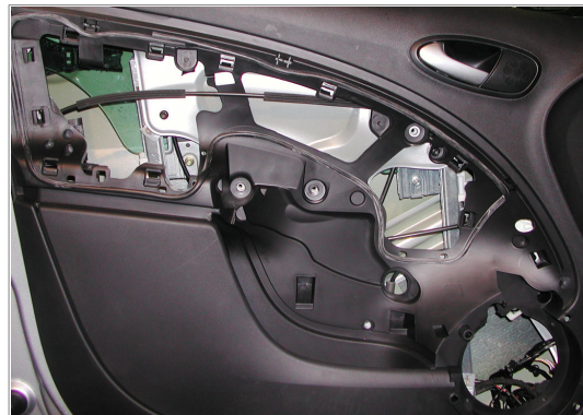
A POWER WINDOW LEFT ALZACRISTALLI ELETTRICO SX
