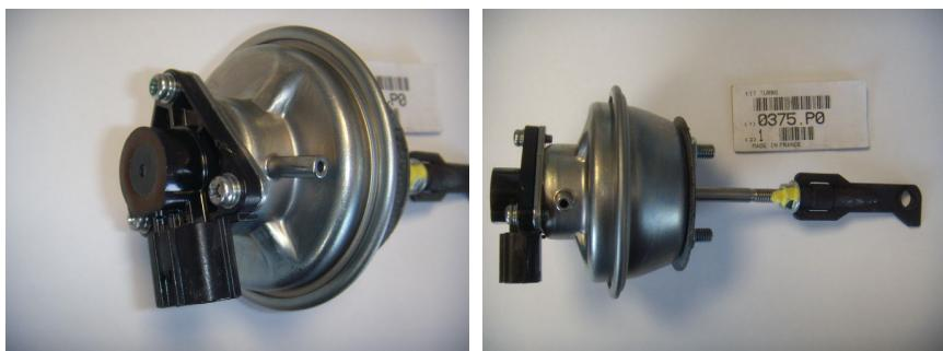
Ez az érzékelő hajlamos a működési hibára (hiba: elektronikus érzékelő a turbófeltöltő geometriai helyzetének átmásolása).
