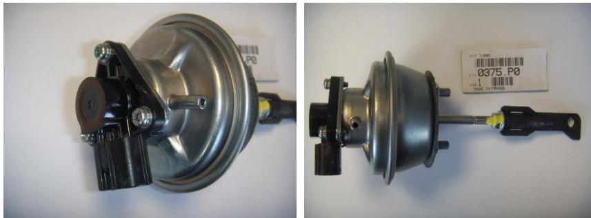
Dieser Sensor tendiert zur Ausgabe von Fehlermeldungen (Fehler im elektronischen Sensor bei der Positionsdetektion der Turbolader-Geometrie).
