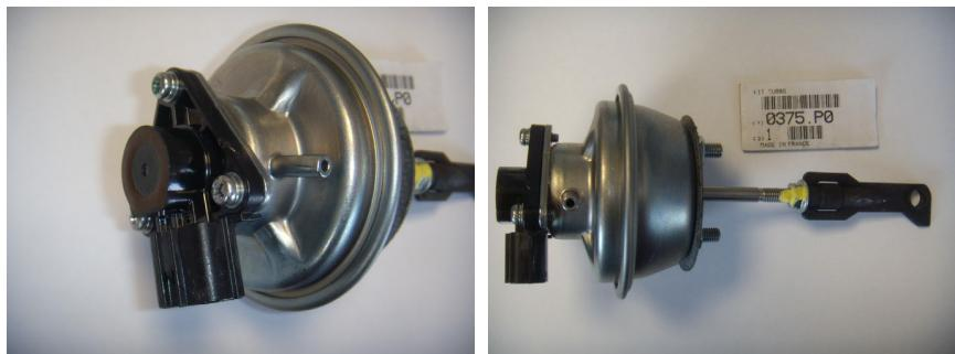
Dicho sensor, es propenso a dar error de funcionamiento (error re-copia sensor electrónico posición de la geometría del turbocompresor).
