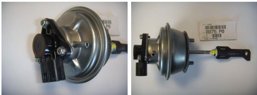
O referido sensor é propenso a dar erro de funcionamento (erro re-cópia sensor eletrónico posição da geometria do turbocompressor).
