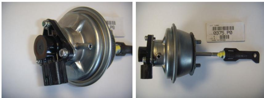
Ten czujnik jest podatny na błąd działania (błąd: czujnik elektroniczny ponownie kopiuje pozycję geometrii turbosprężarki).
