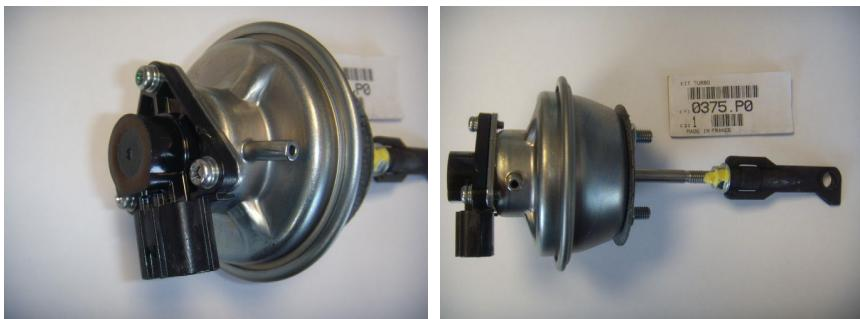
Il suddetto sensore è propenso a dare errore di funzionamento (errore ri-copia sensore elettronico posizione della geometria del turbocompressore).
