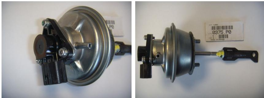
Denne sensor er tilbøjelig til at have en funktionsfejl (fejl: elektronisk sensor kopierer turboladerens geometriposition igen).
