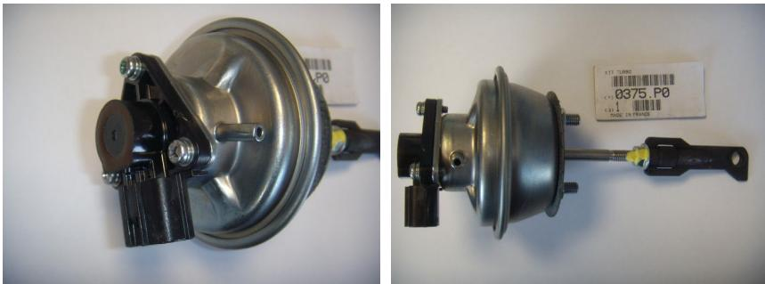
Acest senzor este predispus la o eroare de funcționare (eroare: senzor electronic de recopie a poziției geometrice a turbocompresorului).
