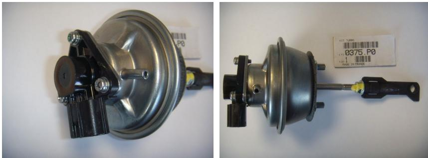
Ce capteur est sujet à des dysfonctionnements (dysfonctionnement : capteur de recopie électronique de position de la géométrie du turbocompresseur).
