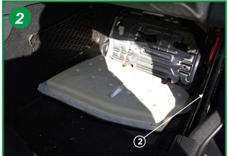
Rabattre le tapis de sol et retirer le joint d'étanchéité de la portière (2) pour dégager les agrafes de fixation du carter flanc de porte (image 3).
