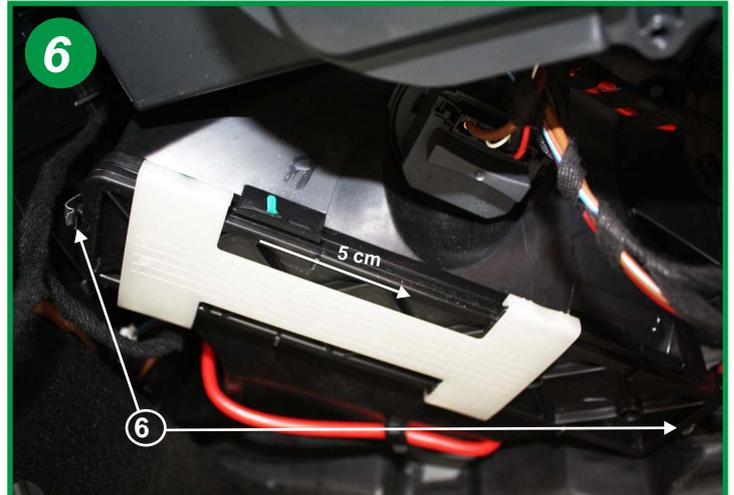
Retirer à l'aide d'un tournevis plat les 2 agrafes de maintien du couvercle du boîtier filtrant (6), attention ces agrafes se désolidarisent du couvercle et peuvent tomber puis faire coulisser le fermoir vers la droite d'environ 5 cm et retirer le couvercle.
