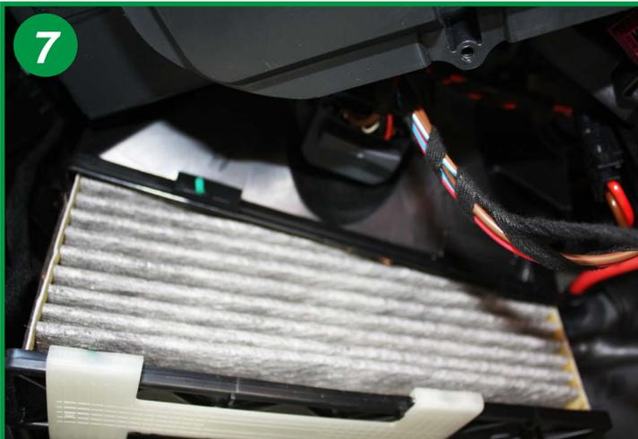
Extraire le filtre usagé par le bas et le remplacer. Le remontage s'effectue dans le sens inverse du démontage.
