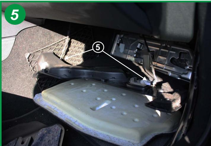
Débrancher les 2 connexions électriques (5) et extraire totalement le carter de protection.
