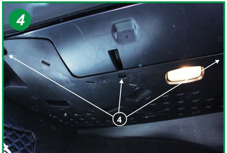
Dévisser les 3 vis Torx T20 (4) et retirer le carter de protection sous la boîte à gants.
