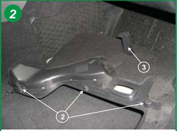
Sous la boîte à gants, dévisser 3 vis torx (repère 2), pour extraire le cache, auparavant dégager la moquette pour faciliter le démontage de ce cache le crochet (repère 3) maintient le cache en place.
