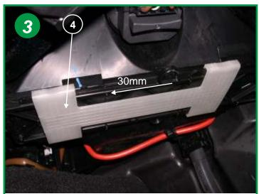
Le boitier est accessible, une trappe coulisse à l'aide d'une pièce plastique (repère 4) sur 4 ergots dans le sens de la flèche sur un longueur de 30 mm. A chaque extrémité de la trappe 2 agrafes de fermeture à retirer.
