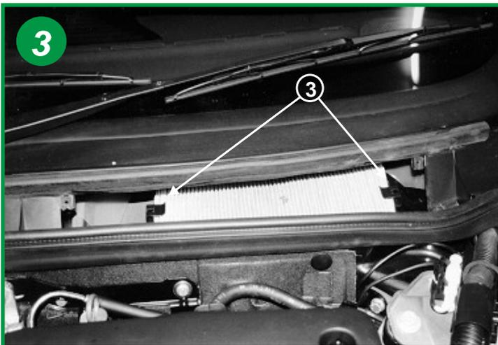
Extraire l'élément filtrant usagé en le tirant vers le haut en basculant les 2 petites languettes (voir flèche 3)
