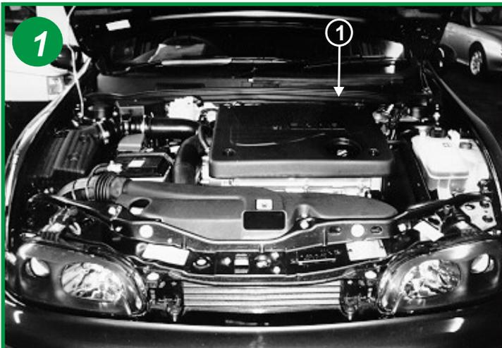
L'élément filtrant est situé sous le capot moteur en dessous de la baie du pare brise coté passager
