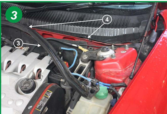
Retirer sur la moitié le joint d'étanchéité moteur (3) et dévisser les 2 vis torx sur le carter (4).
