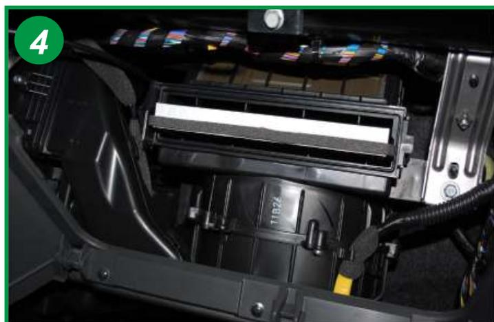
Glisser l'élément filtrant usagé hors de son boîtier et le remplacer. Le remontage s'effectue dans l'ordre inverse du démontage.
