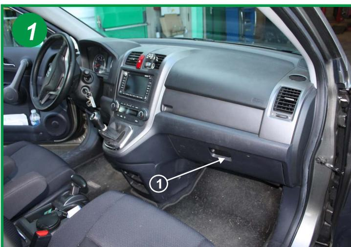
Le filtre d'habitacle est situé à l'intérieur du véhicule, côté passager derrière la boîte à gants inférieure (1). Ouvrir la boîte à gants.
