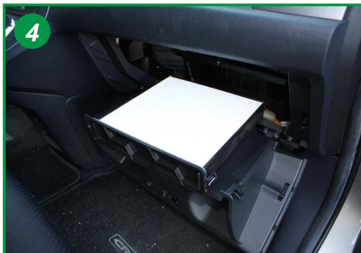
Replacer dans le tiroir un élément neuf. Le remontage s'effectue dans l'ordre inverse du démontage.
