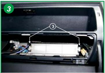
Retirer le couvercle du boitier filtrant en agissant sur les 2 fermoirs (3) à chaque extrémité. Extraire l'élément filtrant usagé et le remplacer. Le remontage s'effectue dans l'ordre inverse du
