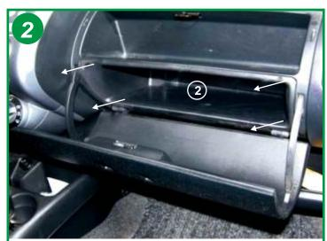
Dé-encliqueter le caisson de la boîte à gants (2). Le retirer totalement.
