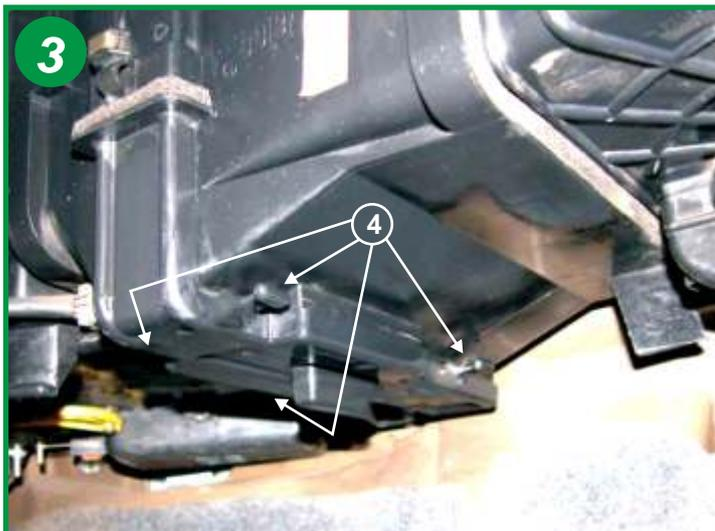
Retirer le couvercle du boîtier filtrant en appuyant fortement sur les 4 poignées (4) prévues à cet effet sur le couvercle.
