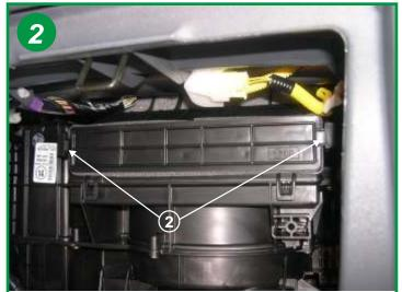
Le boitier du filtre est alors accessible, retirer le tiroir support de filtre en actionnant les poignets à gauche et à droite du couvercle (voir flèche 2)
