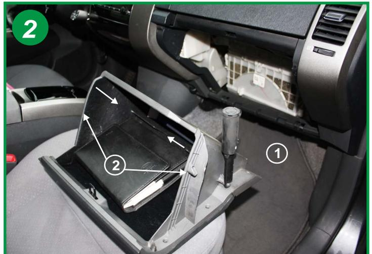
Démonter la boîte à gants, pour cela appuyer sur les flancs du tiroir (2) afin de dégager les ergots de retenue et désaccoupler l'amortisseur (3) puis l'extraire en tirant dessus.
