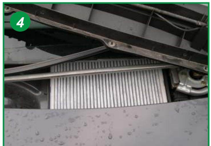
Remplacer le filtre d'habitacle en le positionnant la flèche vers le bas (flèche imprimée sur l'élément). Le remontage s'effectue dans l'ordre inverse du démontage.
