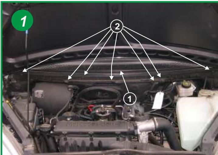
L'élément filtrant est situé sous le capot moteur sous la baie du pare brise au centre. Ouvrir le capot moteur et retirer la grille d'aération (flèche 1) maintenue par 7 vis cruciformes (flèche 2) puis refermer le capot moteur.
