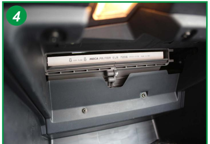
Retirer l'élément filtrant usagé et procéder à son remplacement. Le remontage s'effectue dans l'ordre inverse du démontage.
