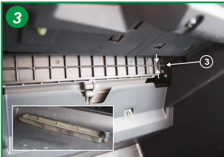
Appuyer sur les pattes du fermail (3) dans le sens des flèches et retirer le couvercle du boîtier filtrant.
