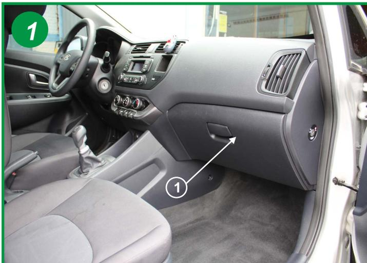
Le filtre d'habitacle est situé à l'intérieur du véhicule, côté passager dans le fond de la boîte à gants (1).
