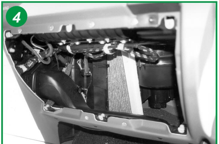
Puis vers le fond afin de le dégager de ses rainures Remplacer le en évitant d'abîmer le joint en mousse autour de l'élément. Le remontage s'effectue alors dans l'ordre inverse du démontage
