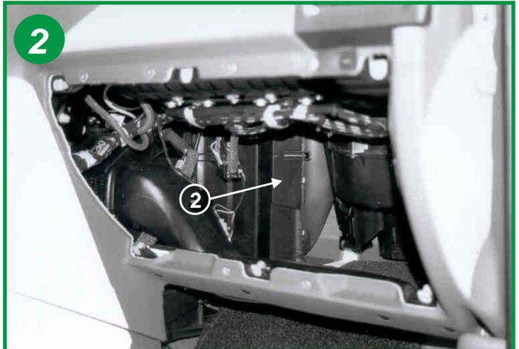
Retirer les 8 clips métalliques de fixation du couvercle en plastique sur le boîtier de l'élément filtrant (voir flèche 2)
