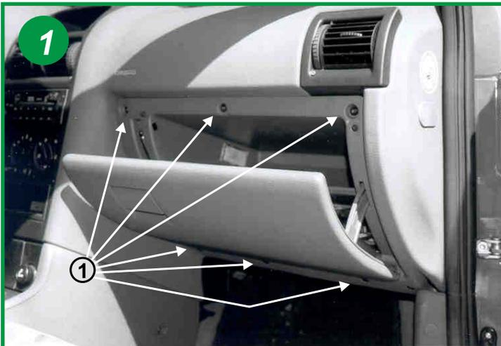
L'élément filtrant est situé derrière la boîte à gants dans l'habitacle du véhicule
