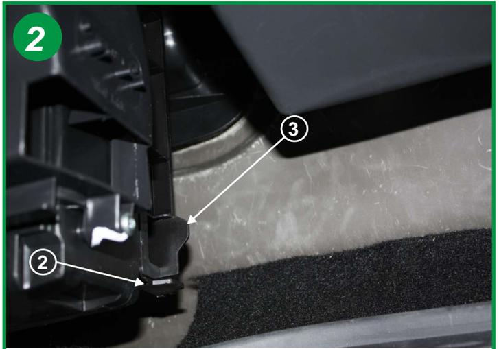
Soulever la petite patte (2) dans la partie inférieure du couvercle du boîtier et tirer sur la poignée (3).
