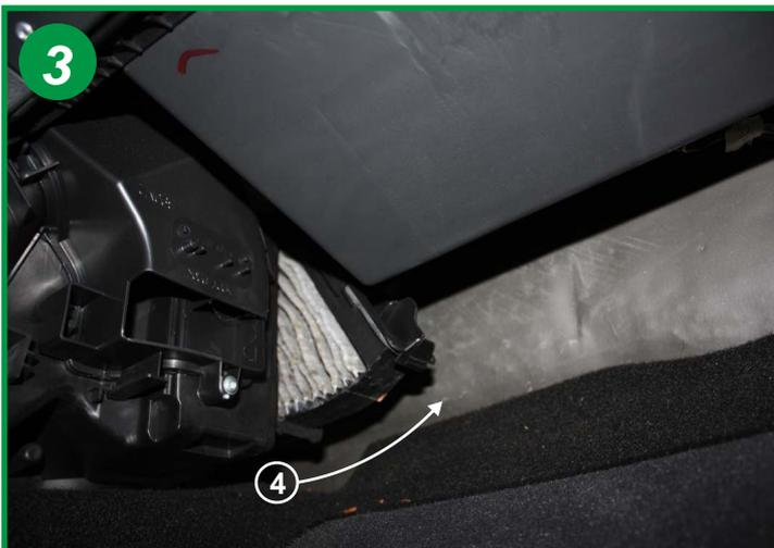
Extraire l'élément filtrant usagé dans le sens de la flèche (4).
