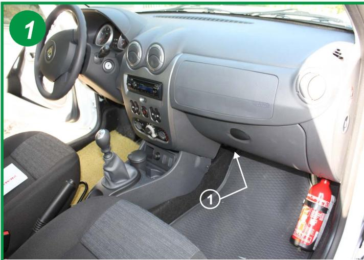
Le filtre d'habitacle est situé à l'intérieur du véhicule, côté passager sous la boîte à gants côté console centrale (1).
