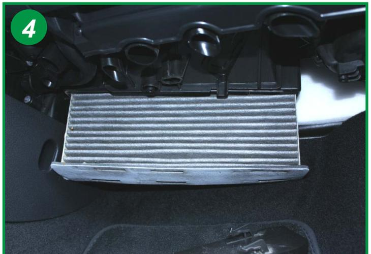
Extraire l'élément filtrant par le bas et procéder à son remplacement. Le remontage s'effectue dans l'ordre inverse du démontage.
