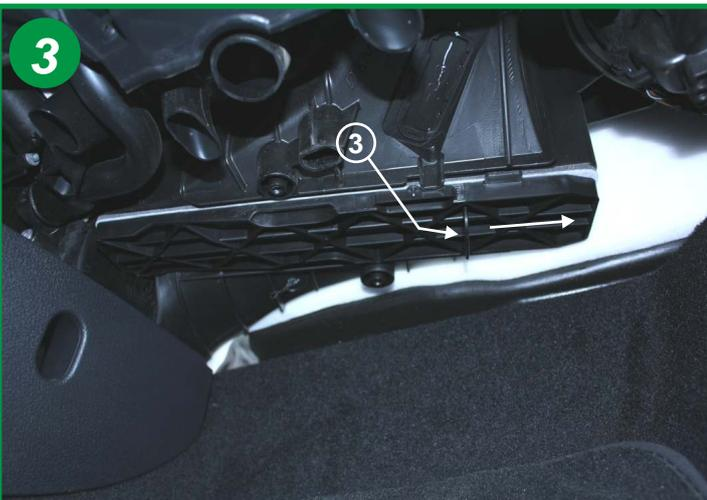
A l'aide de la poignée (3) sur le couvercle du boîtier filtrant, faire coulisser celui-ci dans le sens de la flèche pour dégager les ergots et le retirer.
