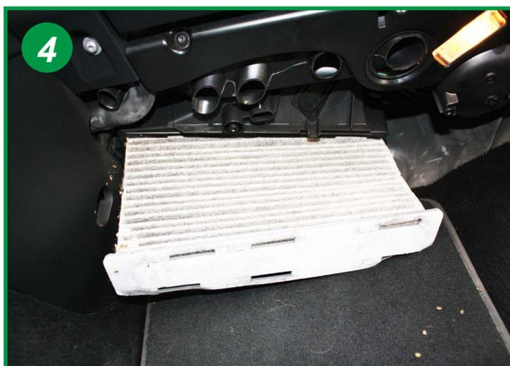
Extraire l'élément filtrant usagé en le tirant vers le bas, procéder à son remplacement. Le remontage s'effectue dans l'ordre inverse du démontage.
