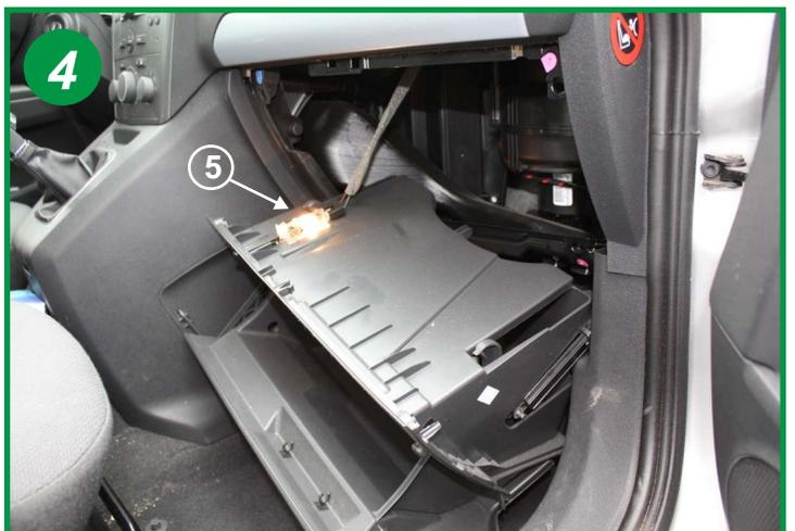
Extraire le bloc boîte à gants dans sa totalité en débranchant la lampe plafonnier de la boîte à gants (5).
