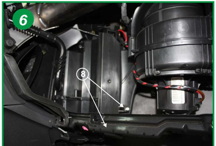
Dévisser ensuite le 2 vis à tête hexagonale (5,5 mm) (8) de fixation du couvercle du boîtier filtrant. La deuxième vis se trouve derrière la barre renfort.
