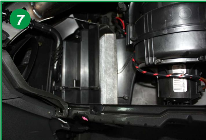
Retirer ce couvercle, l'élément filtrant est alors accessible.
