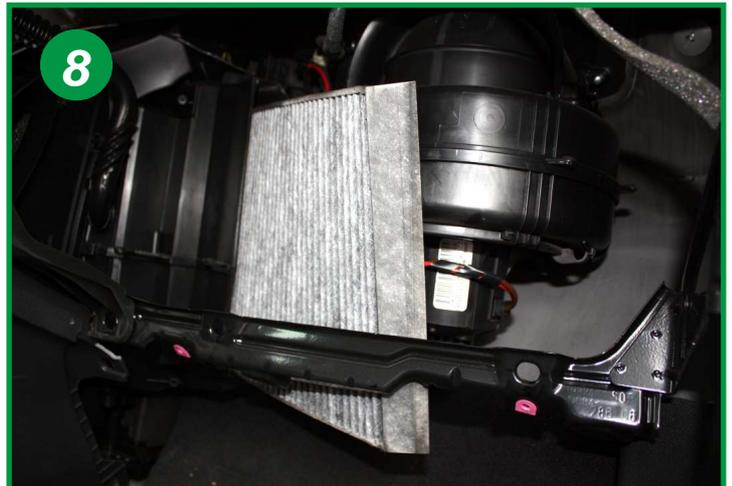
Extraire l'élément filtrant et le remplacer en le déformant légèrement et le sortant par le dessous. Le remontage s'effectue dans l'ordre inverse du démontage.
