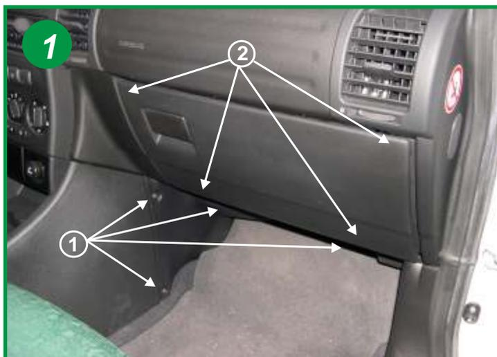
L'élément filtrant est situé derrière la boîte à gants.
