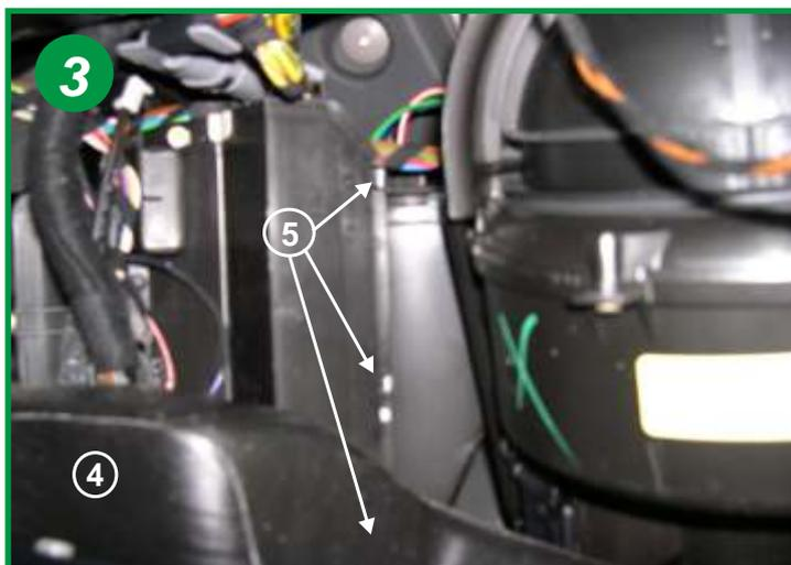
Ouvrir le boîtier filtrant après avoir retiré les 3 clips de fermeture (voir flèche 5).
