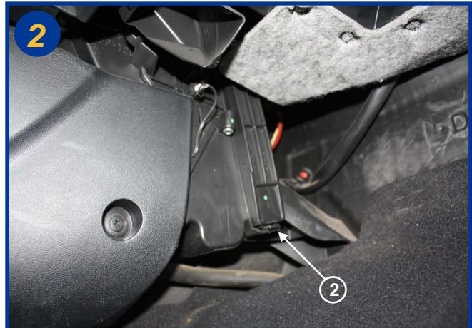
Sous la boîte à gants, ouvrir le boîtier filtrant à l'aide de la patte de fermeture (2). Retirer le couvercle.
