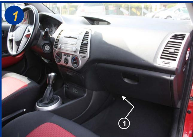
Les filtres d'habitacle sont au nombre de 2, ils sont situés à l'intérieur du véhicule, côté passager sous la boîte à gants côté console centrale (1).
