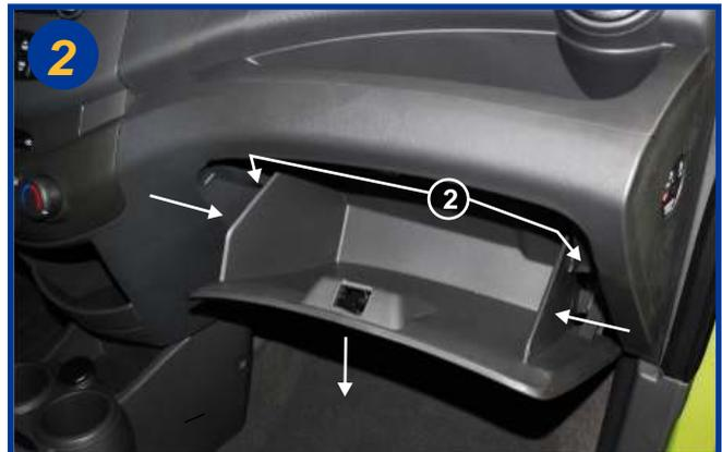
Presser sur les flancs du tiroir de boîte à gants (dans le sens des flèches) afin de dégager les arrêtoirs (2). Basculer le tiroir vers le bas et le sortir de ses gonds. Retirer le tiroir de boîte à gants.
