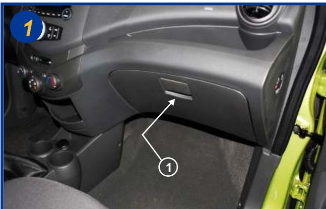
Le filtre d'habitacle est situé à l'intérieur du véhicule, côté passager derrière la boîte à gants (1). Ouvrir la boîte à gants.
