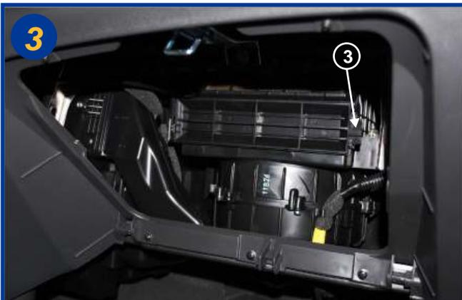
Ouvrir le boîtier filtrant du côté droit (3) en manipulant le loquet de fermeture. Le couvercle étant articulé sur le côté gauche. Extraire le couvercle.
