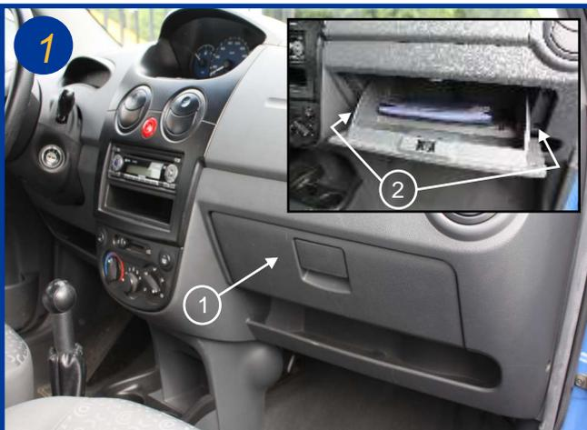
Le filtre d'habitacle est situé à l'intérieur du véhicule, coté passager derrière la boîte à gants (1). Ouvrir la boîte à gants (encadré) et dévisser les 2 vis cruciformes (2).
