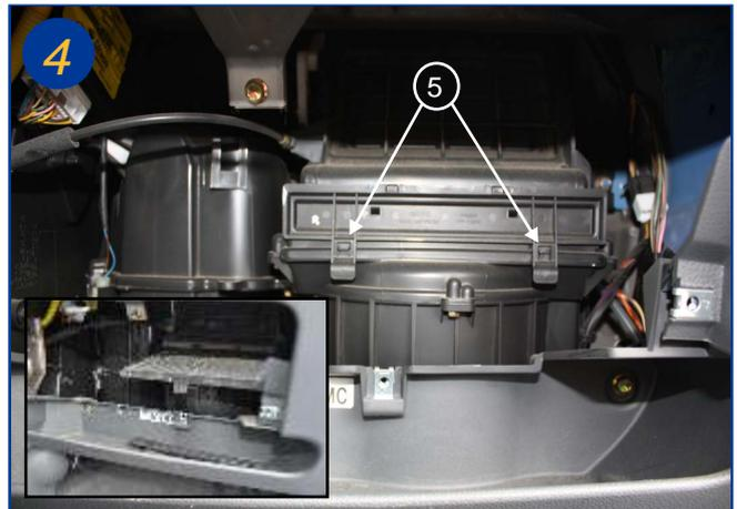
Agir sur les fermetures du couvercle (5) en faisant levier pour extraire le filtre usagé et le remplacer (encadré). Le remontage s'effectue dans l'ordre inverse du démontage.
