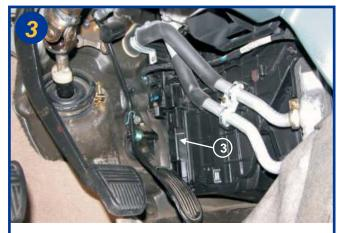
Ouvrir le boîtier filtrant, pour cela retirer le couvercle (3)
