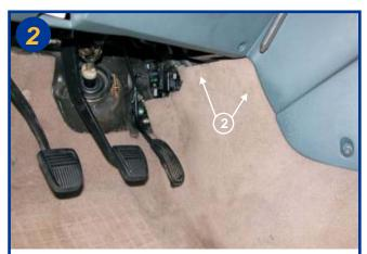
Dégrafer (2) le flanc souple de la console centrale et retirer totalement ce carter.
