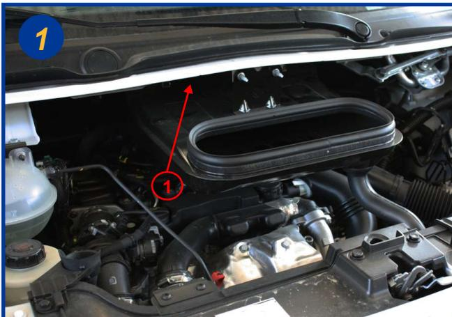
Le filtre d'habitacle est situé sous le capot moteur au centre sous labiaie de pare-brise (1).
