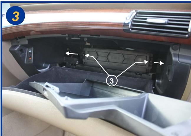
Appuyer sur les 2 languettes (3) vers l'extérieur (voir flèches) et ouvrir le tiroir du boîtier filtrant.
