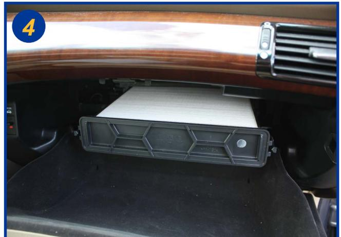
Retirer l'élément filtrant usagé de son cadre et procéder à son remplacement. Le remontage s'effectue dans l'ordre inverse du démontage.
