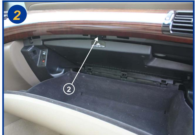
Ouvrir la boîte à gants, déclencher en appuyant sur le levier (2) la descente d'un petit tiroir contenant le manuel d'utilisation du véhicule. Une fois ouvert, l'extraire totalement en tirant dessus.
