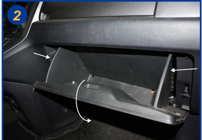
Pressez sur les flancs de la boîte à gants (voir flèches) pour dégager les arrêtoirs et basculer la boîte vers le bas.
