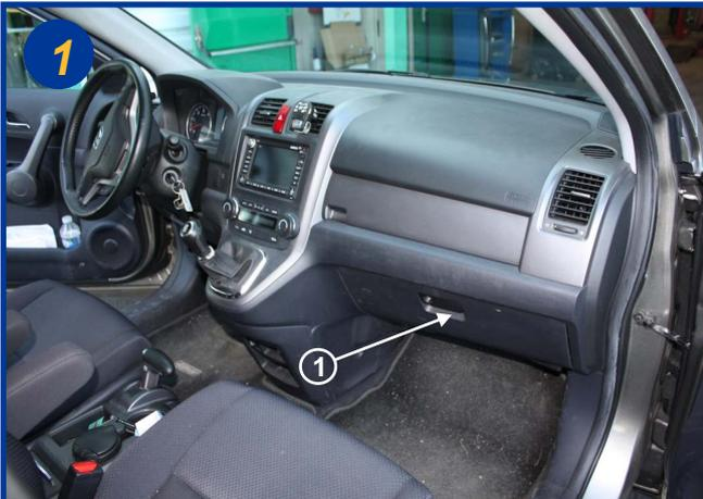
Le filtre d'habitacle est situé à l'intérieur du véhicule, coté passager derrière la boîte à gants inférieure (1). Ouvrir la boîte à gants.
