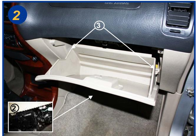
Ouvrir la boîte à gants et dévisser par dessous les 2 vis cruciformes (2)(voir encadré). Puis retirer celle-ci en dégageant les 2 butées d'arrêt (3)
