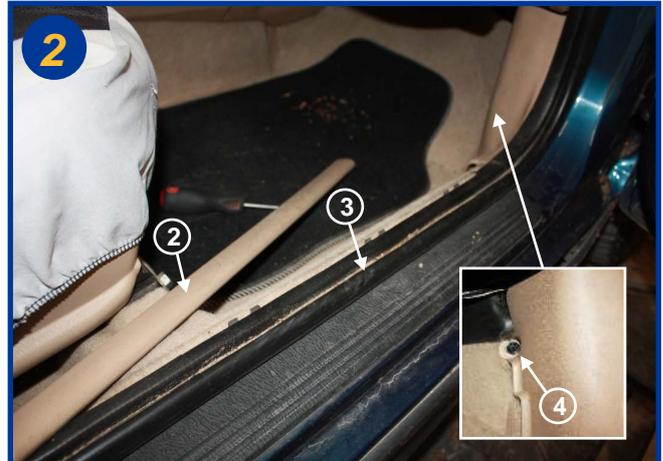
Dégrafer la barre de seuil (2), sortir le joint d'étanchéité (3) sur 20 cm et dévisser l'écrou plastique (4) afin de retirer le carter (voir encadré)
