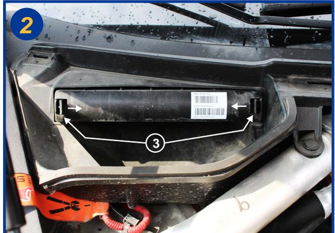
Actionner les 2 loquets de fermeture (3) dans le sens des flèches et ouvrir le boîtier filtrant.
