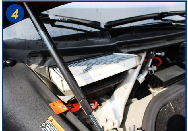
Remplacer le filtre usagé par un filtre neuf.
