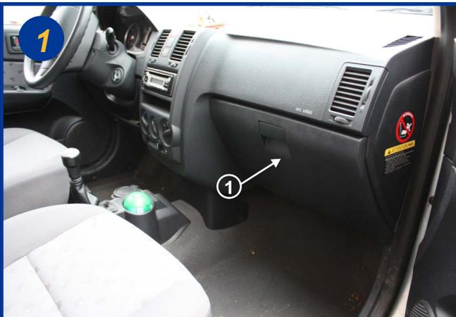
Les filtres d'habitacle sont situés à l'intérieur du véhicule coté passager derrière la boîte à gants (1).
