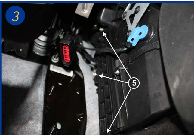
Dévisser les 3 vis de 7 de fixation du couvercle du boîtier filtrant (5). Retirer celui-ci.
