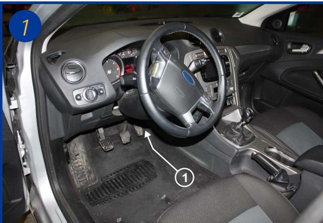
Le filtre d'habitacle est situé à l'intérieur du véhicule coté conducteur, sous le tableau de bord à coté de la pédale d'accélérateur (1).
