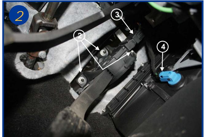
Dévisser les 3 écrous de 10 qui maintiennent en place la pédale d'accélérateur (2) débrancher le connecteur (3) et retirer celle-ci. Débrancher également le connecteur bleu (4).
