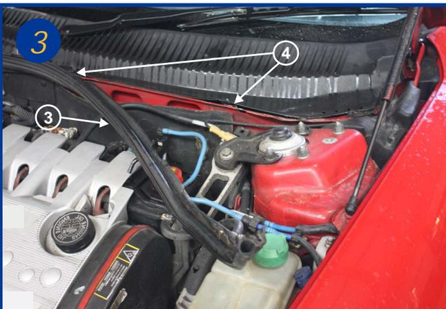
Retirer sur la moitié le joint d'étanchéité moteur (3) et dévisser les 2 vis torx sur le carter (4).
