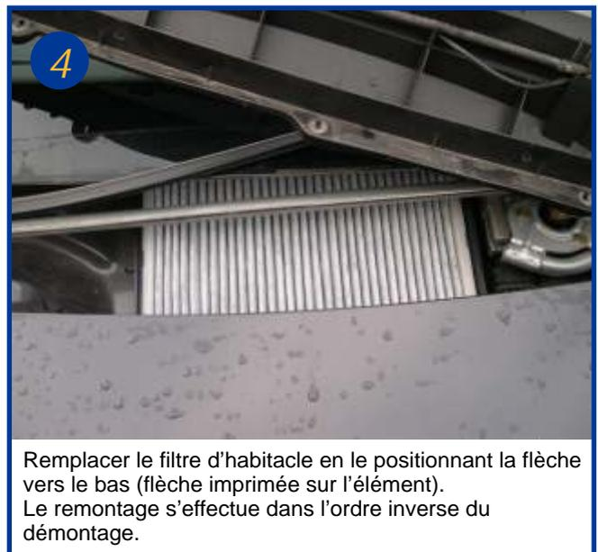
Remplacer le filtre d'habitacle en le positionnant la flèche vers le bas (flèche imprimée sur l'élément). Le remontage s'effectue dans l'ordre inverse du démontage.
