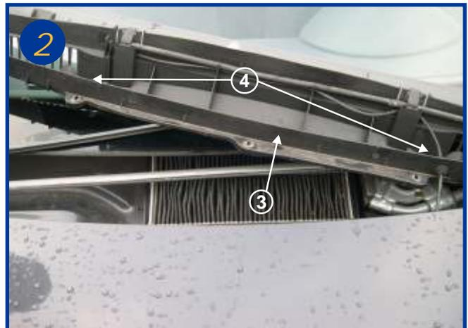
Retirer ensuite les 2 balais d'essuie glaces puis soulever le cache plastique (flèche 3) fixé par 2 vis cruciformes (flèche 4) pour avoir accès au boîtier de filtre.
