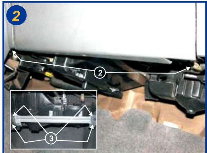
Dévisser les 2 vis cruciformes (2) et retirer la boîte à gants dans sa totalité. Puis les 3 vis cruciformes et la vis de 10 mm (3) pour retirer la traverse métallique.
