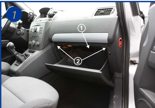
Le filtre d'habitacle est situé à l'intérieur du véhicule coté passager, derrière la boîte à gants (1). Ouvrir celle-ci et dévisser les 2 vis torx (T20) (2).
