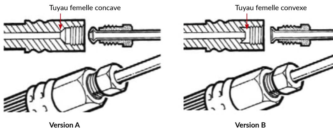
**Version A** - Raccord de tuyau femelle concave pour accepter une bride de tuyau convexe
