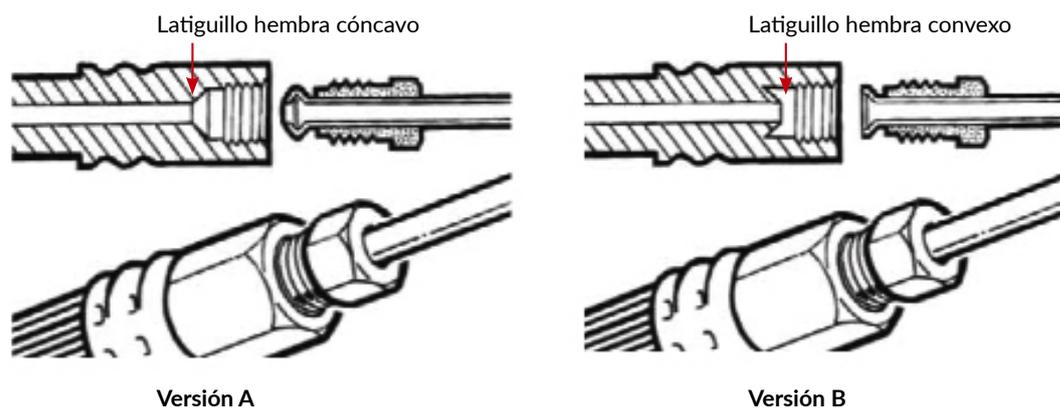
Utilice los siguientes diagramas para identificar el tipo de latiguillo de su vehículo **Versión A**- Conexión hembra cóncava del latiguillo para recibir una brida de tubo convexa **Versión B** - Conexión hembra convexa del latiguillo para recibir un tubo acampanado cóncavo.
