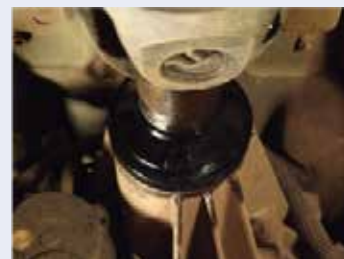
Parapolvere modificato montato in posizione corretta
