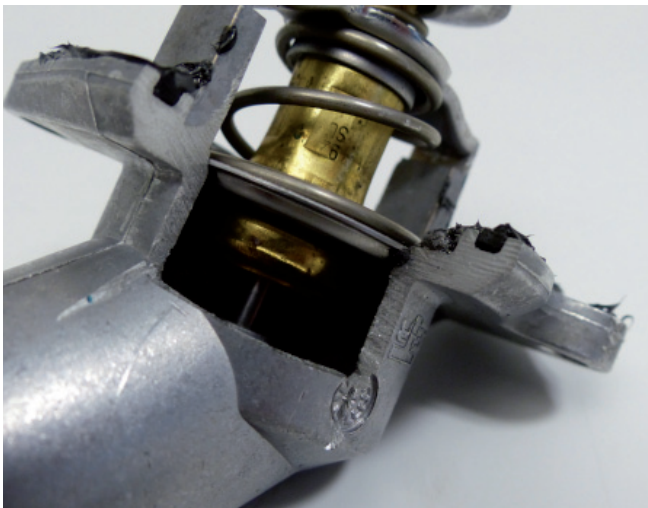
Der Eintrag von Dichtpaste hat dazu geführt, dass das Thermostat nicht mehr vollständig schließt.
