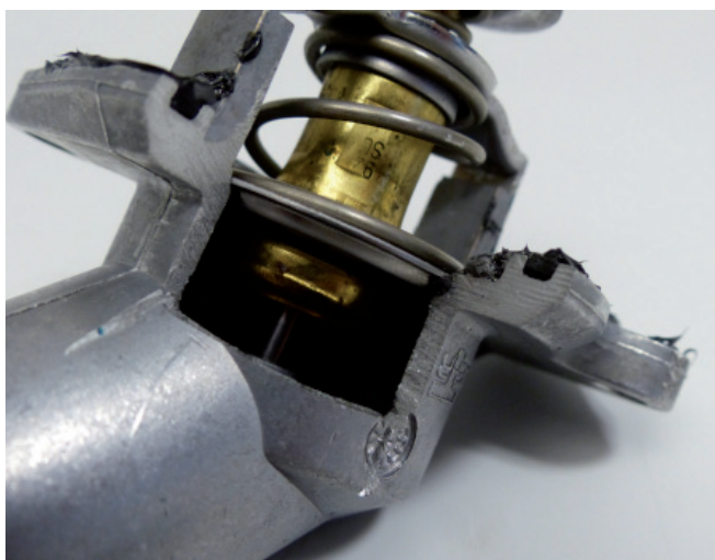
Suite à l'utilisation de pâte d'étanchéité, le thermostat ne se ferme plus complètement.
