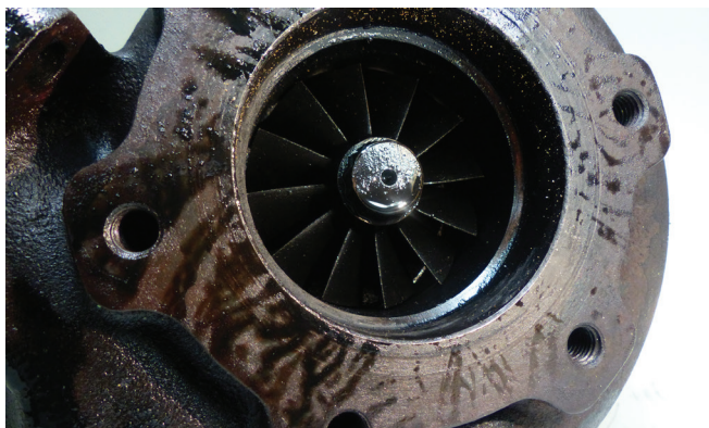
Ilustracja 1: Olej na wylocie turbiny turbosprężarki
