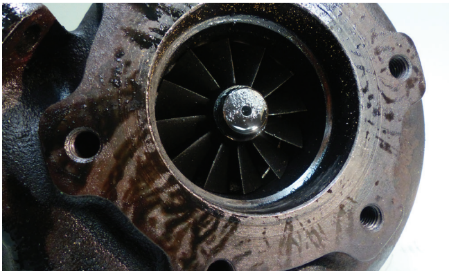
Figura 1: Aceite en la salida de turbina del turbocompresor
