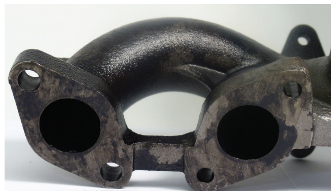
Abbildung 2: Öl dringt bereits am Turbineneintritt ein
