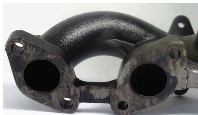
Figure 2: De l'huile pénètre déjà à l'entrée turbine
