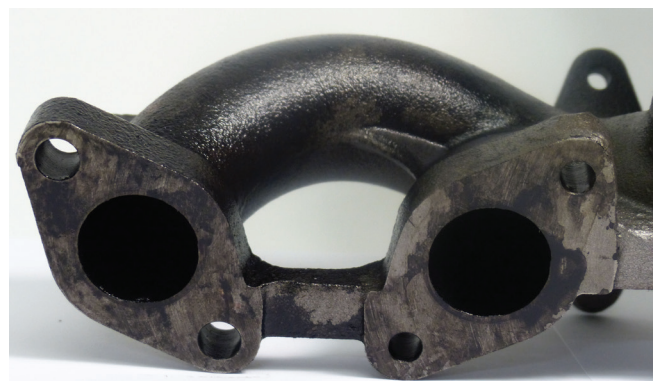
Рисунок 2: Масло уже попало во впускной патрубок турбины
