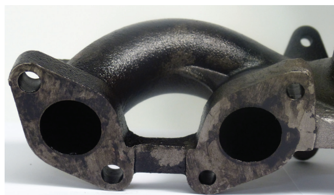
Εικόνα 2: Το λάδι εισέρχεται ήδη στο στόμιο εισόδου του στροβίλου
