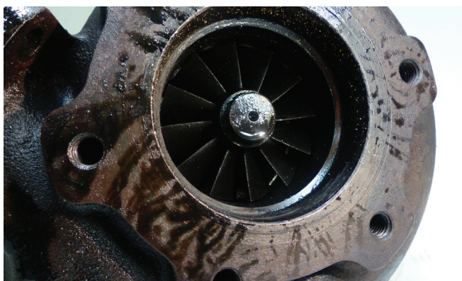
Figure 1: Perte d'huile à la sortie turbine du turbocompresseur
