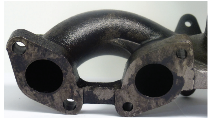
Figura 2: El aceite ya ha penetrado en la entrada de turbina
