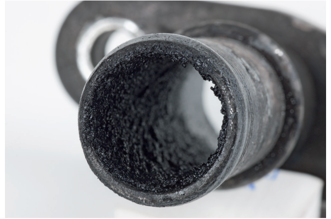
Resim 4: İçeri giren egzoz gazları nedeniyle kurumlanan yağ geri dönüş hattı.
