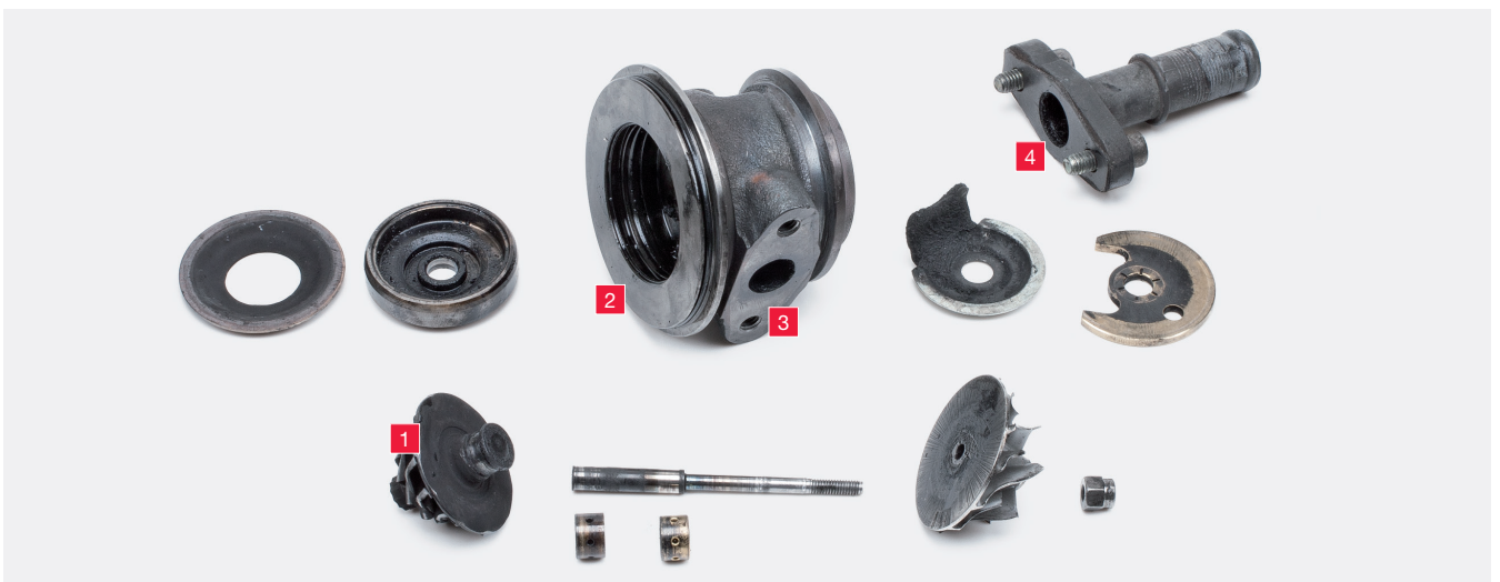
Figura 2: La ruta de los gases de escape por el interior del turbocompresor: a través de la rueda de turbina 1 hacia la carcasa del cojinete 2 y, a continuación, a través de la salida de aceite 3 hacia el conducto de retorno 4
