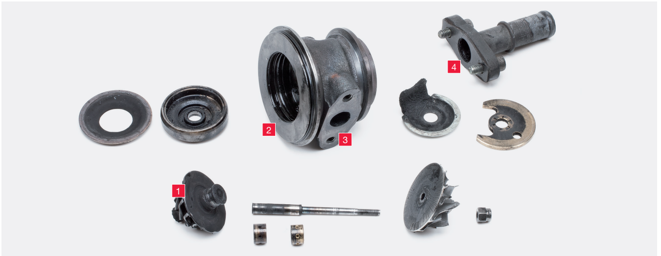
Resim 2: Egzoz gazlarının turboşarj içerisinden geçerken izlediği yol – türbin çarkı 1 üzerinden, yatak gövdesine 2 ve oradan yağ çıkışı 3 içerisinden, geri akış borusuna 4
