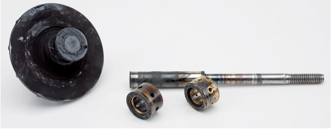
Resim 3: Radyal yatakların iyi yağlanmaması nedeniyle kırılan rotor mili
