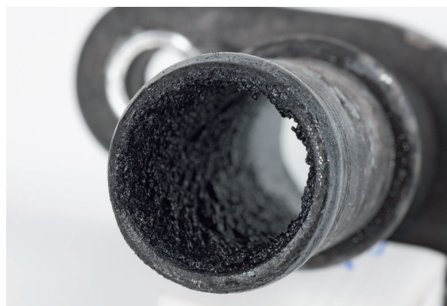
Ilustracja 4. Przewód powrotny oleju pokryty nagarem wskutek wnikania spalin
