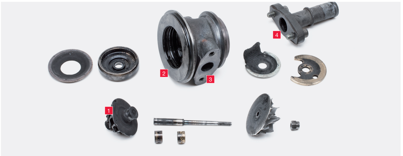
Δίοδος καυσαερίων από το στροβιλοσυμπιεστή – μέσω του στροβίλου 1 στο περίβλημα ρουλεμάν 2 και μετά μέσω του στομίου εκροής λαδιού 3 στον αγωγό επιστροφής 4
