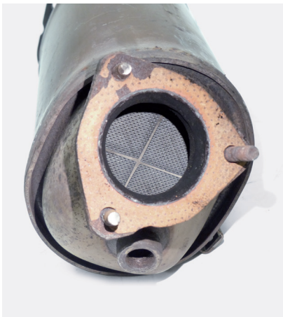
Figure 1 : Filtre à particules diesel démonté
