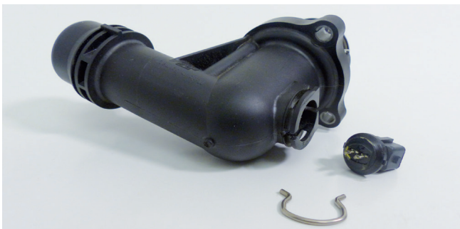
Εικόνα 1: Θερμοστάτης χαρακτηριστικού πεδίου με ξεβιδωμένο συνδετήρα συγκράτησης και φθαρμένη σύνδεση
