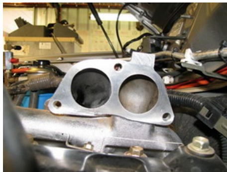
Čisté sací potrubí.
