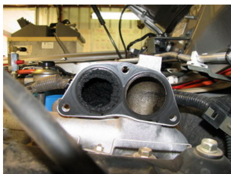
Coletor de admissão obstruído.
