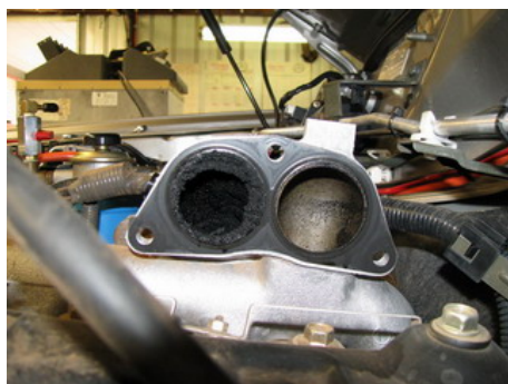
Zaslepené sací potrubí.
