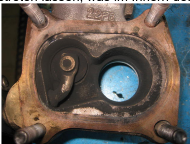
Korrekt montierte Dichtung.
