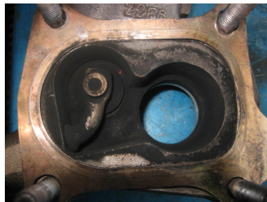
Nesprávně namontované těsnění
