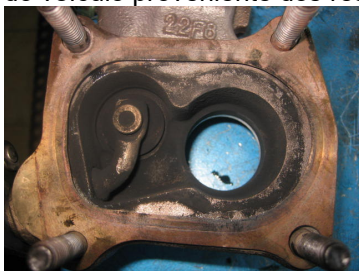
Junta montada corretamente
