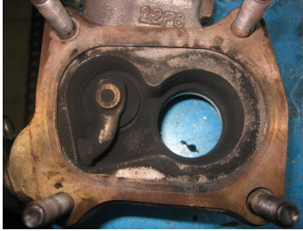
Junta montada correctamente.
