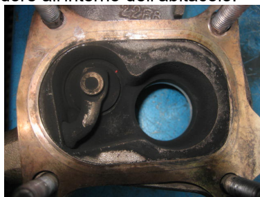
Guarnizione montata non correttamente
