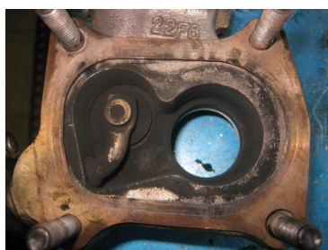
Guarnizione montata correttamente.
