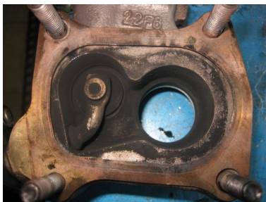
Správně namontované těsnění
