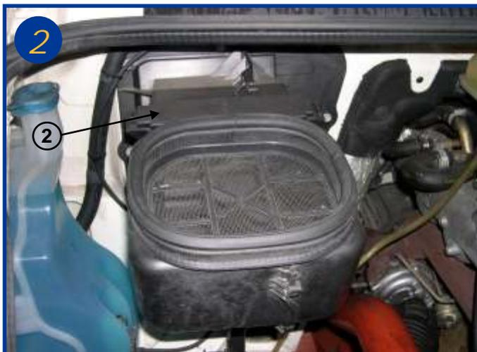
Le boîtier filtrant se trouve juste derrière la bouche d'aération (voir flèche 2).
