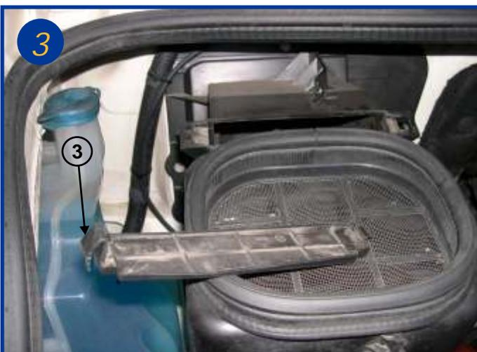
Retirer le couvercle du boîtier filtrant en exerçant une pression sur la patte de fermeture (voir flèche 3).
