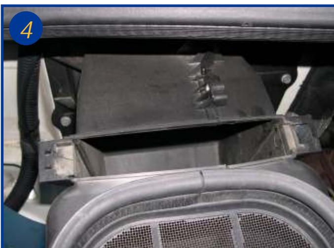
Extraire l'élément filtrant usagé en le tirant vers le haut. Le remontage s'effectue dans l'ordre inverse du démontage.
