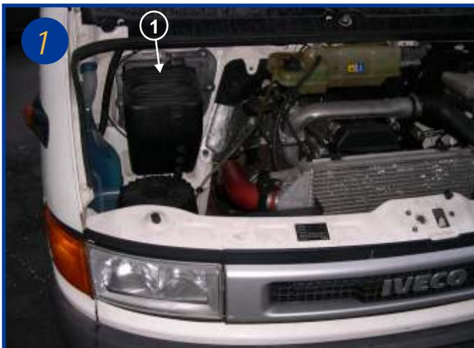
L'élément filtrant est situé sous le capot moteur dans le conduit de la bouche d'aération (voir flèche 1). Ouvrir le capot moteur.
